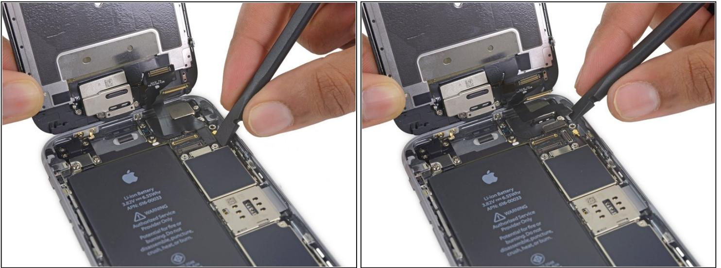
⚠ Der Akku muss abgetrennt sein, bevor du das Kabel in diesem Schritt ablöst oder wieder verbindest
