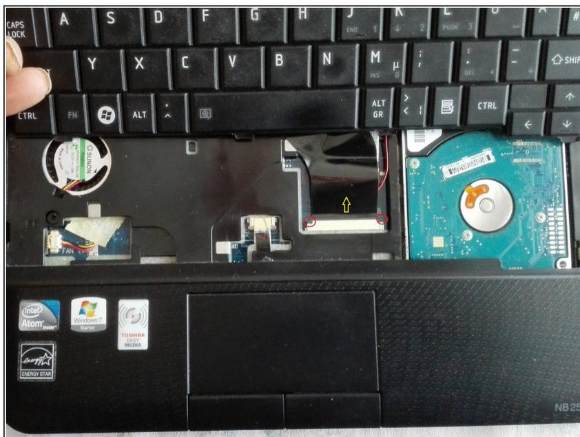
**⚠** Schieben Sie die Tastatur vorsichtig in Richtung Bildschirm bis der Anschluss des Tastaturkabels sichtbar wird.
