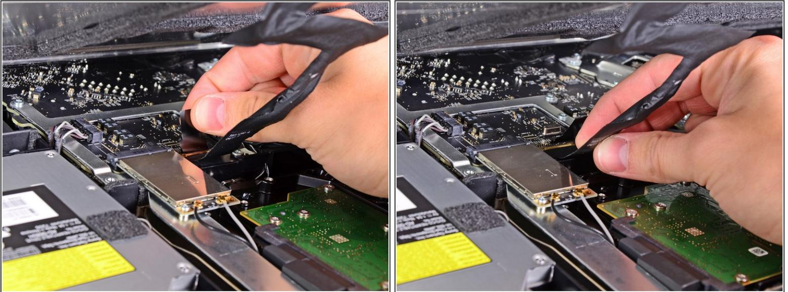
**⚠** Das Displaydatenkabel hat einen Verschlussbügel aus Draht. Entriegele den Verschluss, indem du die Plastiklasche nach oben drehst. (Es ist keine Zuglasche)
