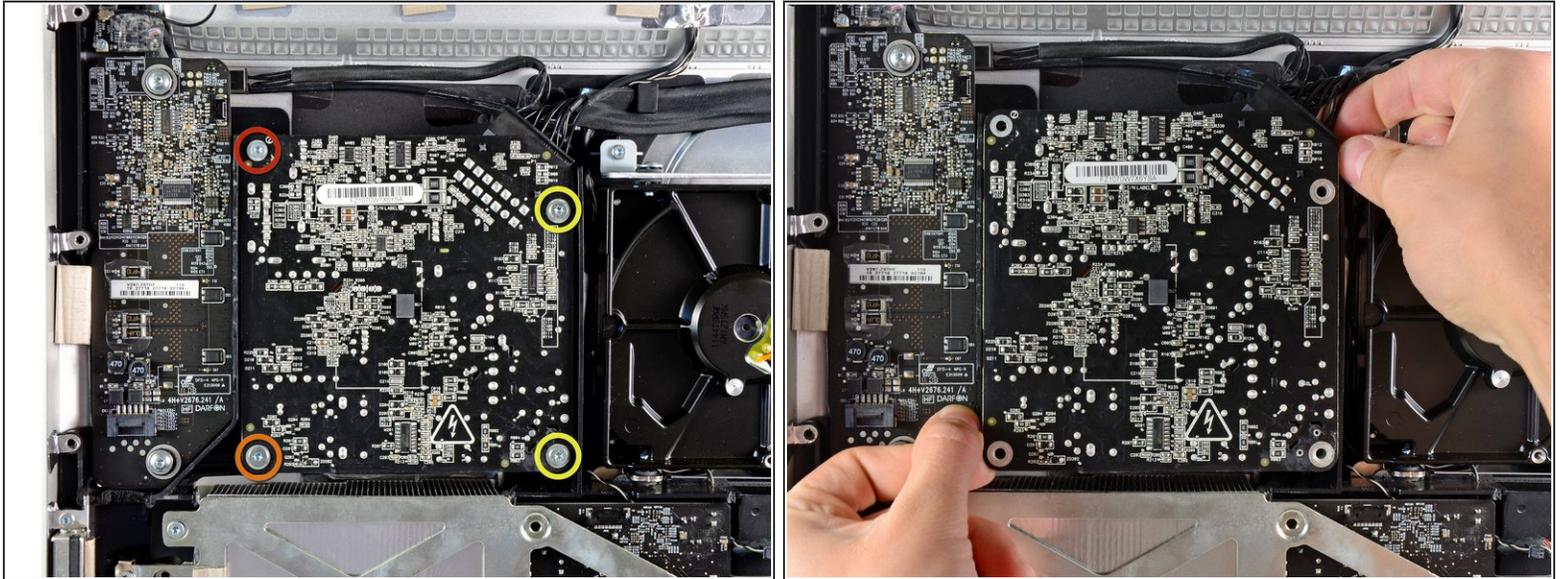
**⚠ Sei sehr vorsichtig und berühre keine Lötstellen auf der Rückseite des Netzteils. Die Kondensatoren können noch ausreichend geladen sein, um dir einen gefährlichen Stromschlag zu versetzen.**
