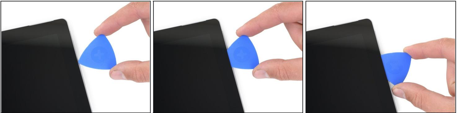
**⚠ Unter der Oberkante des Displays befinden sich empfindliche Antennenkabel. Folge der Prozedur sehr sorgfältig, um Schäden zu vermeiden.**
