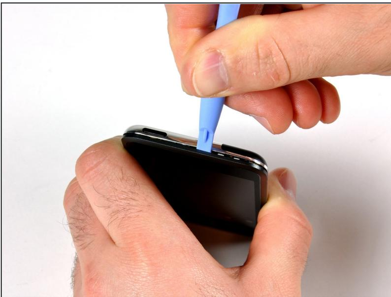
**⚠** Das Öffnen des Gehäuses ist schwer und möglicherweise gefährlich. Eine Menge Kraft ist erforderlich, um das Öffnungswerkzeug aus Kunststoff zwischen die Nähte des Gehäuses zu hebeln. Das Gehäuse kann beschädigt werden, wenn dieser Schritt nicht korrekt ausgeführt wird. Achte beim Öffnen des iPod darauf, dich nicht zu verletzen.
