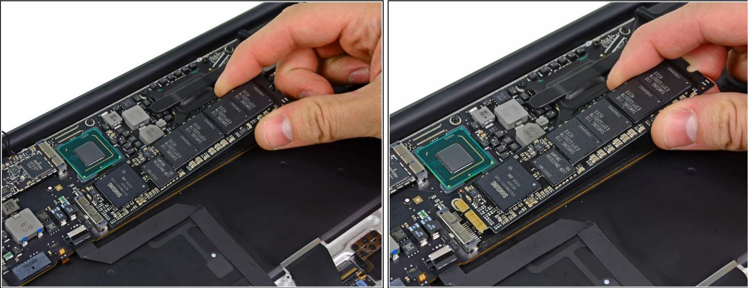
**⚠ Um Schäden am Anschluss zu vermeiden, hebe das Ende der SSD nicht zu stark an.**
