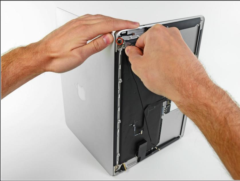
**!** Bevor du die letzte Displayschraube entfernst, achte darauf, dass du das Display und den oberen Gehäuseteil mit deiner einen Hand stabil festhältst. Andernfalls können Komponenten auf den Tisch fallen und potenziell großen Schaden verursachen.
