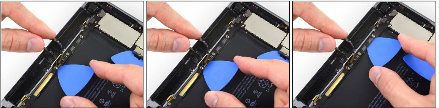
**⚠** In den nächsten Schritten wirst du den Kleber lösen, mit dem das Logic Board befestigt ist. Heble am Anfang immer ganz vorsichtig und prüfe, ob der Kleber schon weich ist. Wenn das nicht der Fall ist, dann erwärme den iOpener erneut und lege ihn auf die Rückseite des Rückgehäuses auf.
