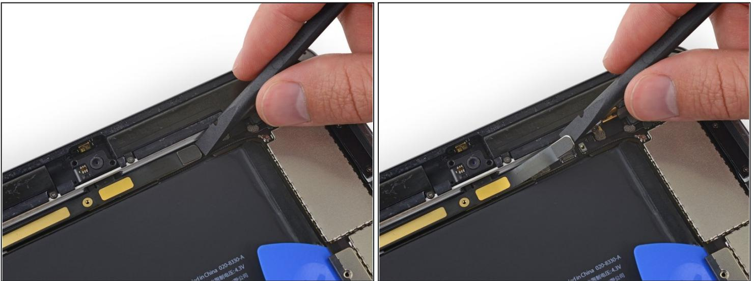
**⚠ In den folgenden Schritten musst du viele Press-Fit-Stecker aus ihren Anschlüssen auf dem Logic Board lösen. Achte beim Lösen dieser Stecker darauf, dass du nur am Stecker selbst hebelst, nicht am Anschluss.**
