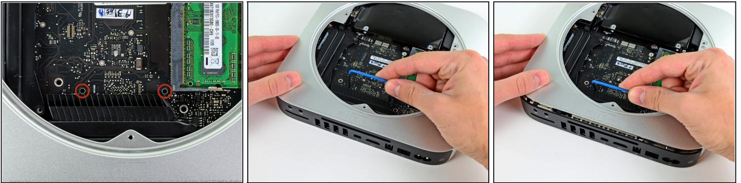
**⚠** Um die Hauptplatine zu entfernen müssen die beiden zylindrischen Stäbe des Mac Mini Logic Board Removal Tools in die beiden rot markierten Öffnungen eingeführt werden. Führt man Instrumente in irgendwelche anderen Öffnungen als die rot markierten auf dem Logic Board ein, kann es zerstört werden.
