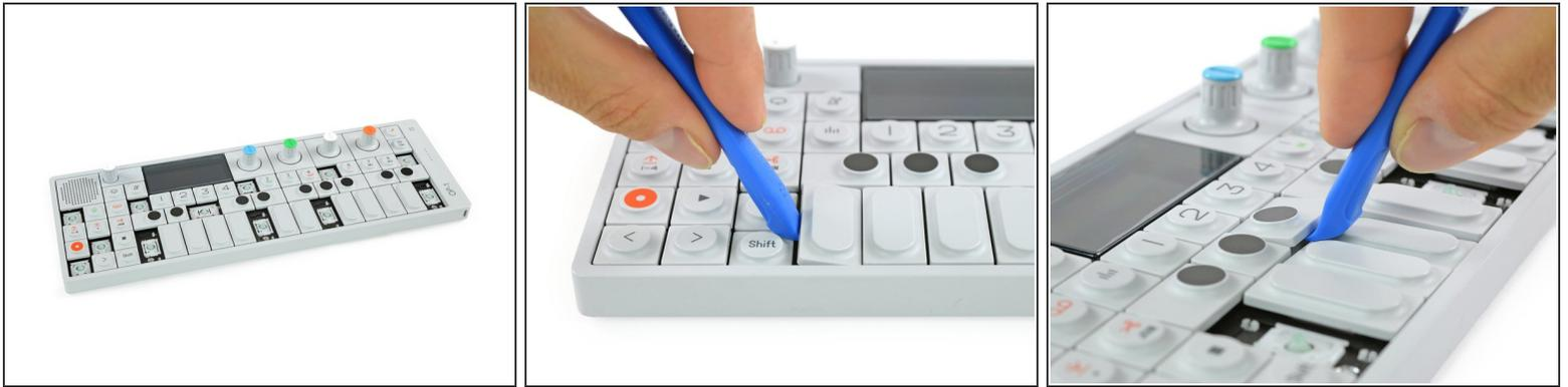
**i** Um an die Schrauben unter dem Keyboard zu kommen, musst du einige Tasten entfernen. Dafür kannst du entweder ein Opening Tool oder ein Opening Pick verwenden. Das erste Bild zeigt, welche Tasten entfernt werden müssen (insgesamt zwölf Stück).
