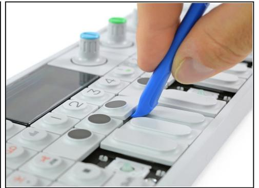
ⓘ Um an die Schrauben unter dem Keyboard zu kommen, musst du einige Tasten entfernen. Dafür kannst du entweder ein Opening Tool oder ein Opening Pick verwenden. Das erste Bild zeigt, welche Tasten entfernt werden müssen (insgesamt zwölf Stück).
