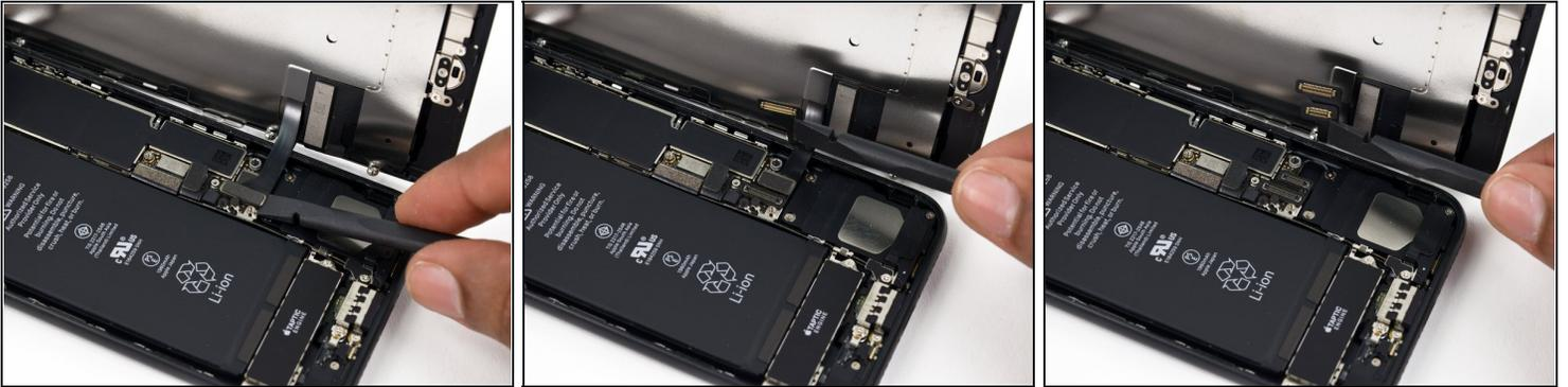
**⚠** Bevor du in diesem Schritt ein Kabel ablöst oder wieder verbindest, musst du den Akku abtrennen.
