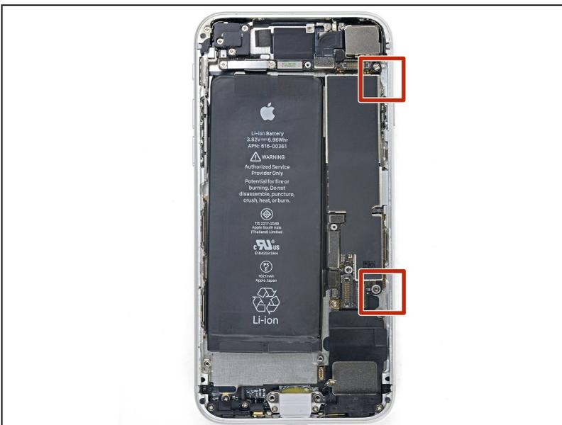
⚠ An der rechten Seitenkante verlaufen empfindliche Kabel. **Setze das Plektrum an diesen Stellen nicht ein**, die Kabel könnten beschädigt werden.
