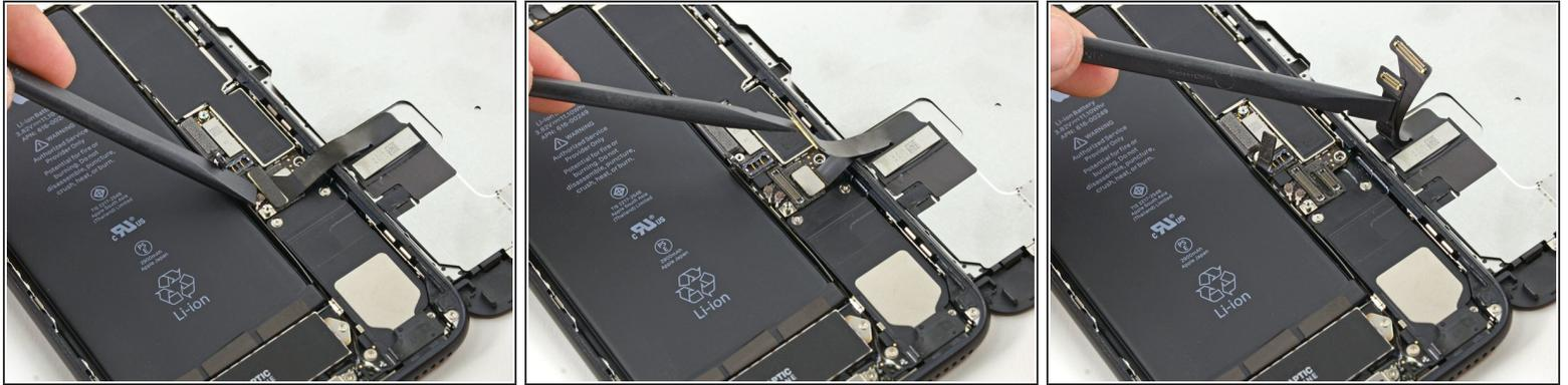
**⚠** Bevor du in diesem Schritt Kabel ablöst oder anschließt, musst du den Akku abtrennen.
