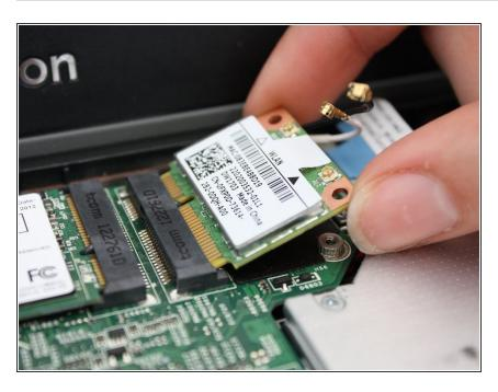
At an angle, slide out the wireless mini card.
