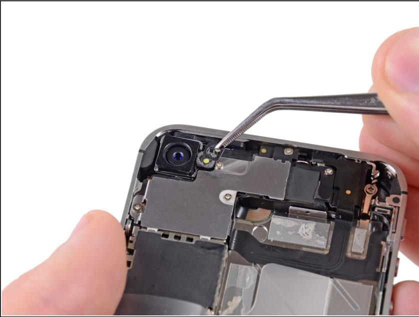
**⚠** Beachte den äußeren Plastikring, der auf dem Blitz der Rückkamera aufliegt. Er kann leicht verloren gehen, wenn er bei der Demontage nicht entfernt wird.
