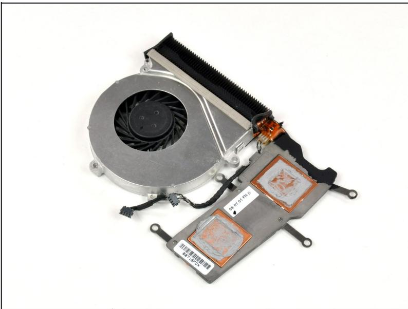
**⚠** Wärmeleitpaste ist zuständig für die Übertragung von Wärme vom Prozessor zum Kühlkörper. Der Zusammenbau eines Computers ohne Wärmeleitpaste führt zu einer Überhitzung des Prozessors und schädigt diesen nachhaltig.
