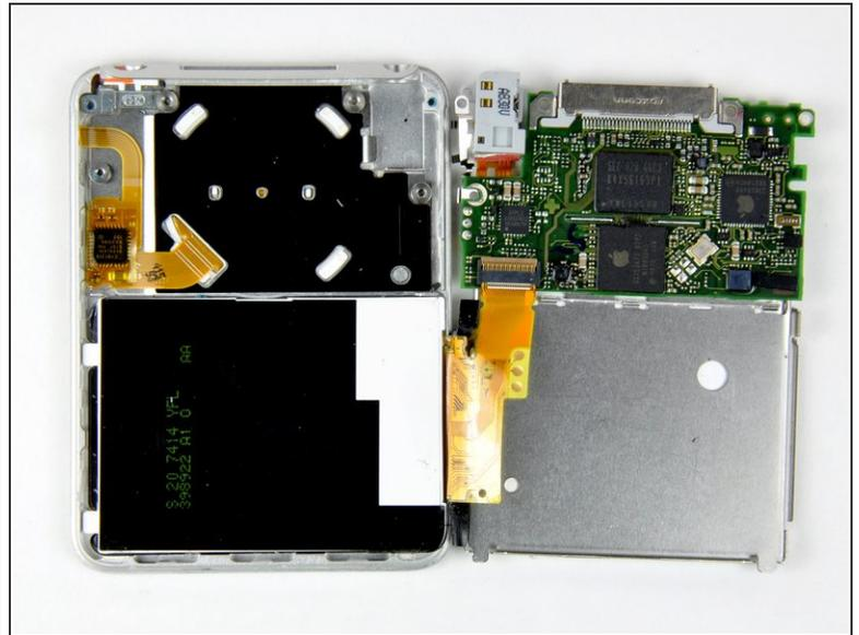
**!** Das Logic Board ist immer noch mit dem vorderen Gehäuseteil durch das Display-Flachbandkabel verbunden. Es befindet sich auf dem Logic Board an der Seite mit der Kopfhörerbuchse.
