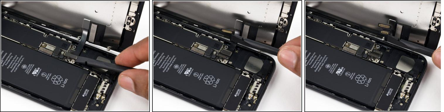
**⚠** Bevor du in diesem Schritt ein Kabel ablöst oder wieder verbindest, musst du den Akku abtrennen.
