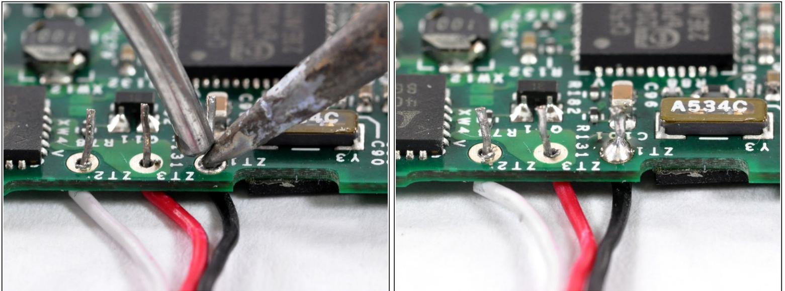
**i** In diesem Schritt werden die Akkukabel an die Lötstellen des Logic Boards gelötet.
