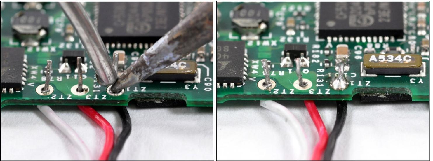
ⓘ In diesem Schritt werden die Akkukabel an die Lötstellen des Logic Boards gelötet.
