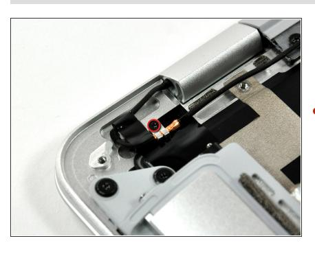
Entferne die einzelne Kreuzschlitzschraube von der Erdungsklammer des
