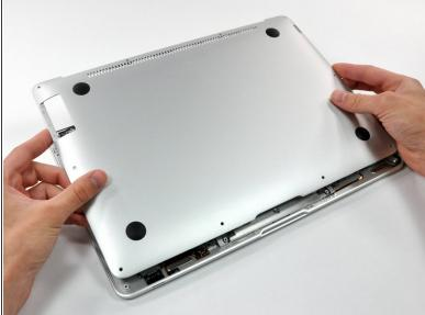
Hebe das Gehäuseunterteil in der Nähe der Lüftungsöffnungen leicht an und schiebe es in Richtung hinteres Ende des Computers. Du löst dadurch die Haltezungen.
