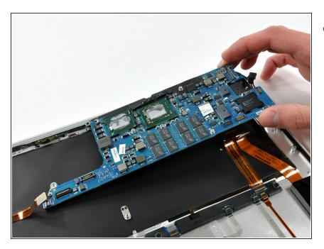
Hebe das Logic Board aus dem oberen Gehäuse heraus.
