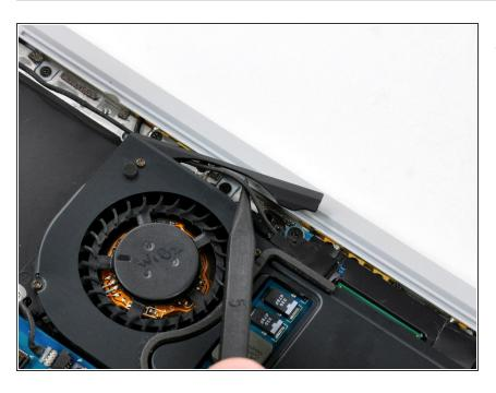
Löse das Mikrofonkabel aus dem Kanal im Lüfter.
