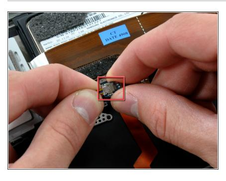
Löse den Verbinder des Audiokabels aus seinem Sockel auf der kleinen Platine.
