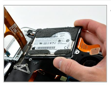
Hebe die Festplatteneinheit aus dem oberen Gehäuse.
