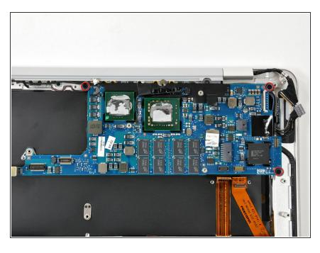
Entferne die drei Kreuzschlitzschrauben, mit denen das Logic Board am oberen Gehäuse befestigt ist.
