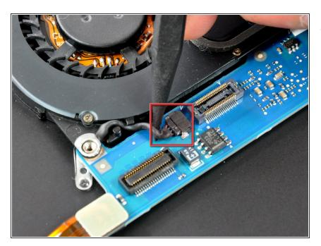
Ziehe den Stecker am Lüfterkabel mit der Spudgerspitze gerade aus seinem Anschluss auf dem Logic Board heraus.
