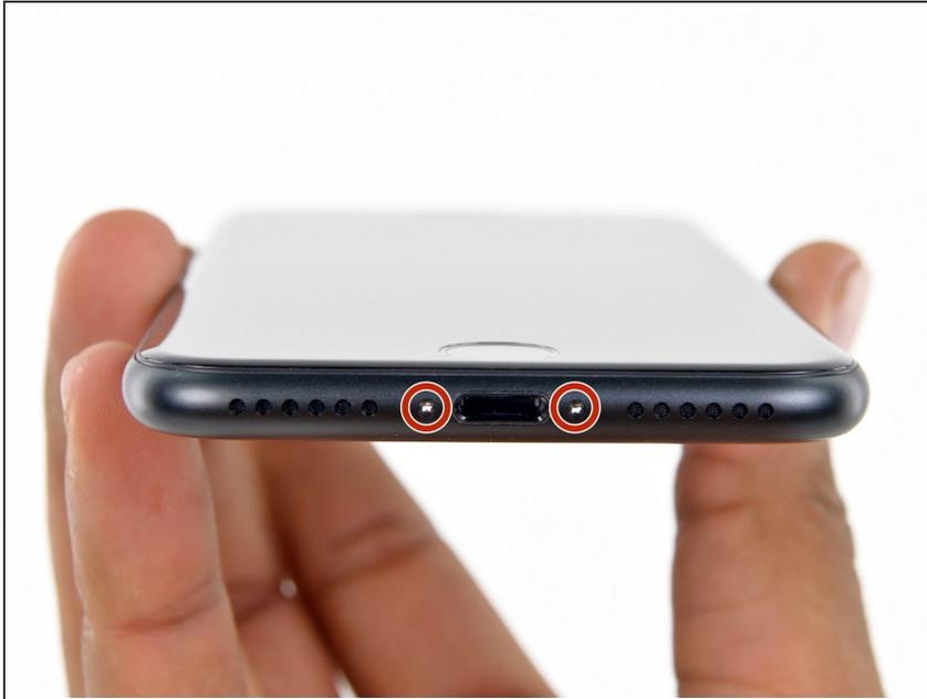
**⚠** Vor dem Beginn sollte der Akkuladestand des iPhones unter 25 % liegen. Ein geladener Lithium-Ionen Akku kann bei Beschädigung Feuer fangen oder explodieren.
