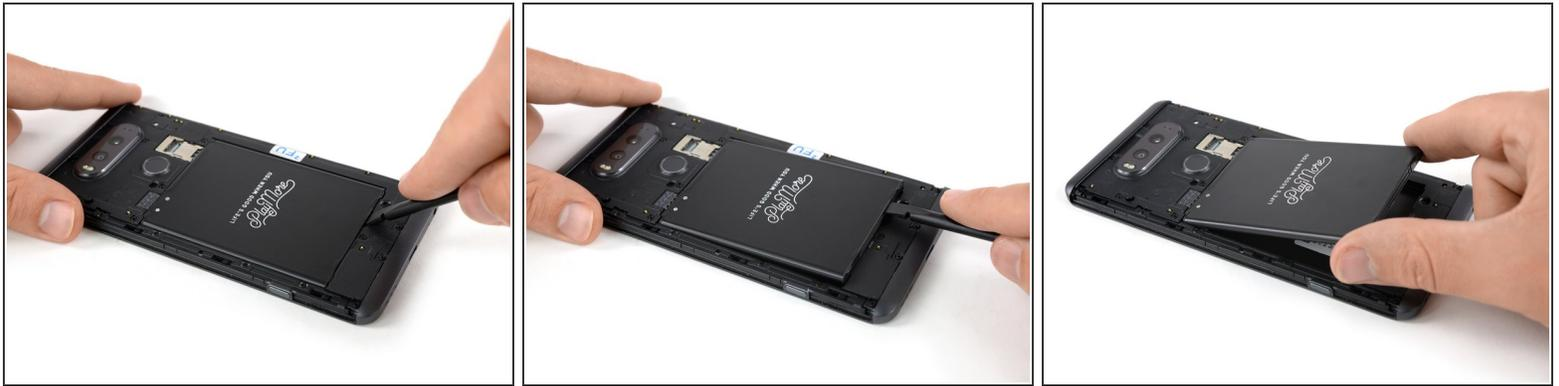
**⚠** Entlade den Akku vor der Reparatur auf unter 25%. Ein geladener Lithium-Ion Akku kann sich entzünden und/oder explodieren, falls er versehentlich perforiert oder beschädigt wird.
