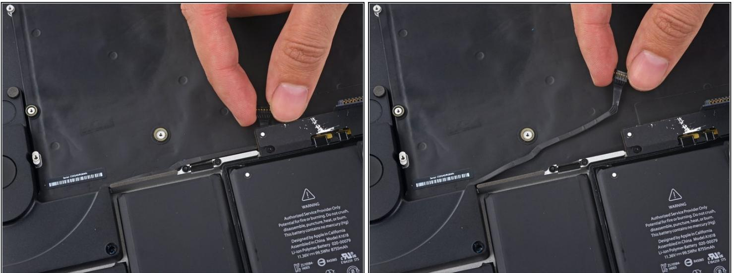
**i** Das rechte Lautsprecherkabel ist leicht am oberen Gehäuse angeklebt.
