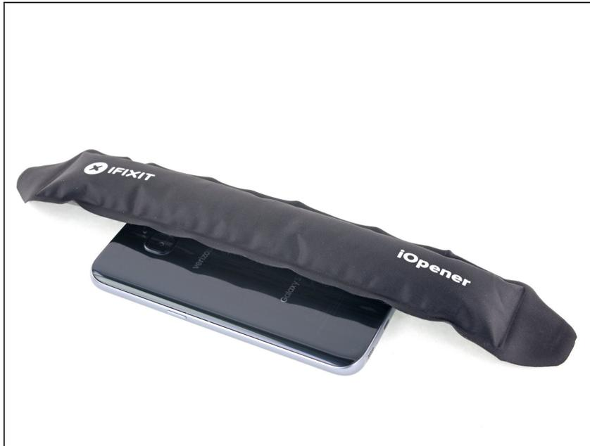
**i** Das Öffnen deines Handys wird die Dichtungen für die Wasserfestigkeit beschädigen. Halte Ersatzkleber parat bevor du weitermachst, oder achte darauf, dass keine Flüssigkeiten an das Handy herankommen, wenn du es ohne Kleber wieder zusammenbaust.
