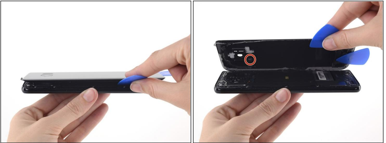
ⓘ Das Kabel des Fingerabdrucksensors verbindet das Handy mit der Rückscheibe in der Nähe der Kamera. Das Kabel ist sehr kurz und löst sich beim Entfernen der Rückscheibe.
