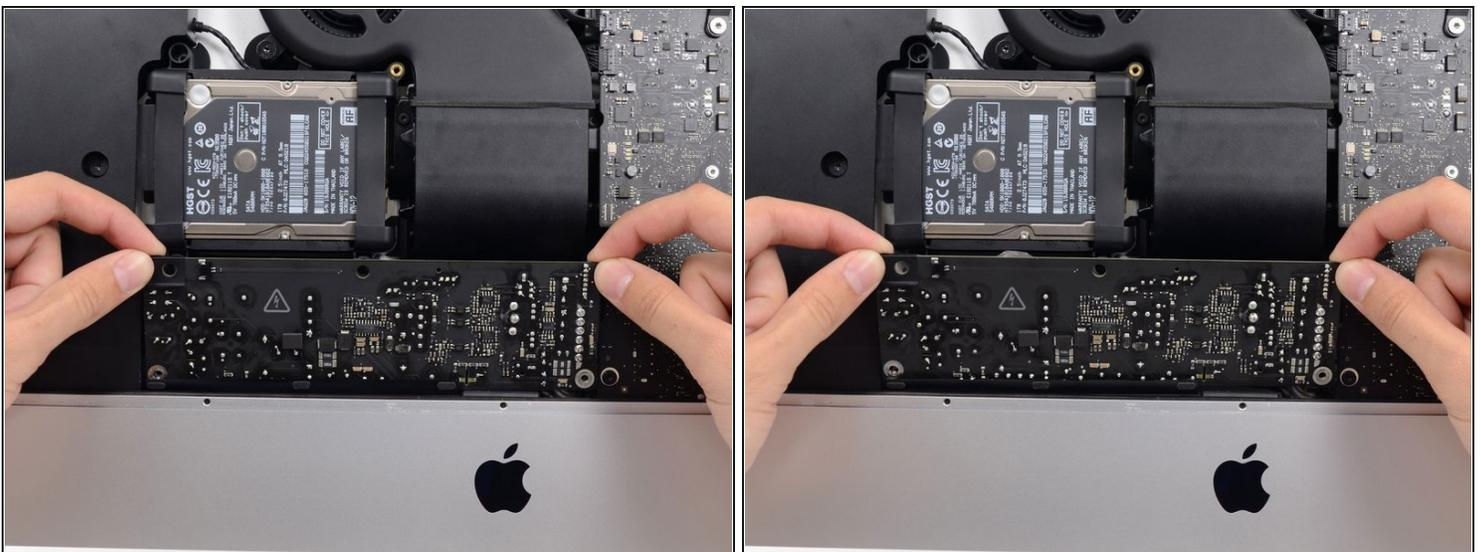
⚠ Wenn du am Netzteil arbeitest, **musst du sehr vorsichtig sein**: berühre keine Kondensatoranschlüsse oder auch Lötstellen auf der Rückseite. Fasse die Platine nur an den Kanten an.
