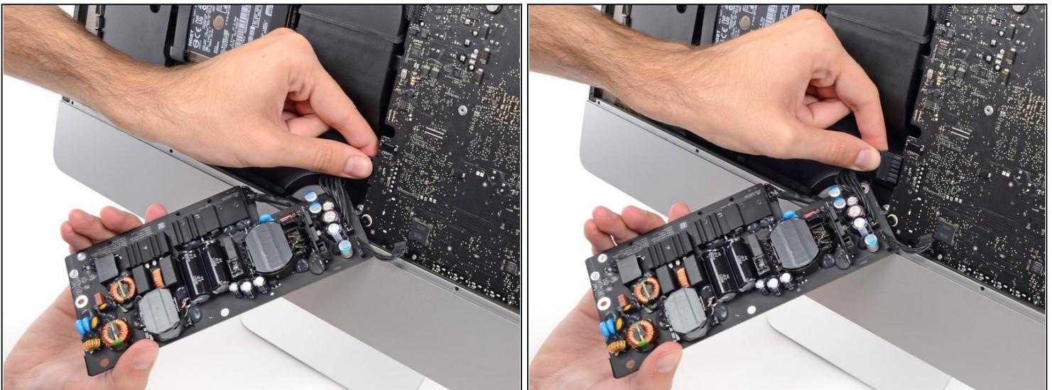
**⚠ Sei ganz vorsichtig** und berühre keine Lötstellen oder Kondensatorkabel auf der Rückseite der Versorgungsplatine. Fasse nur die Kanten an.
