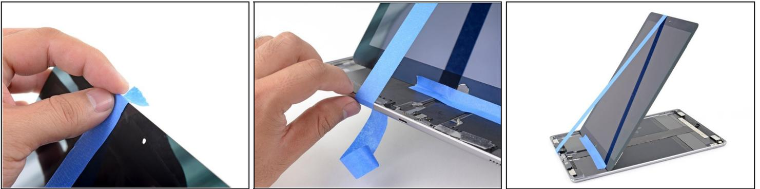
ⓘ In diesem Schritt wird eine Möglichkeit gezeigt, wie du das Display mit Malerband unterstützen kannst. [Du kannst das iPad auch zur Seite drehen](#). Achte bei jeder der Methoden darauf, dass die Displaykabel nicht zu stark angespannt werden.
