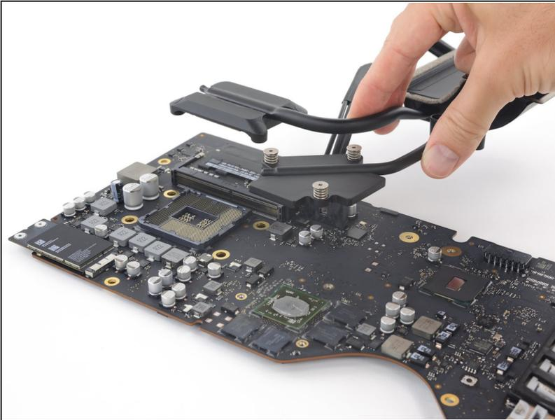
**⚠** Wahrscheinlich wird die CPU beim Herausheben an der Unterseite des Kühlkörpers kleben bleiben. Achte darauf, dass sie nicht beschädigt wird.
