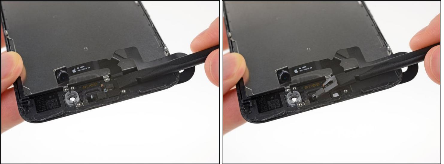
**⚠** Die Sensoren bei diesem Schritt sind sehr empfindlich. Um sie möglichst ohne Beschädigungen zu entfernen, solltest du das obere Teil des Displays mit einem iOpener oder einem Haartrockner erwärmen, bevor du weiterarbeitest. Du kannst vor dem Hochhebeln auch eine oder zwei Tropfen Isopropylalkohol auftragen und unter die Sensoren dringen lassen.
