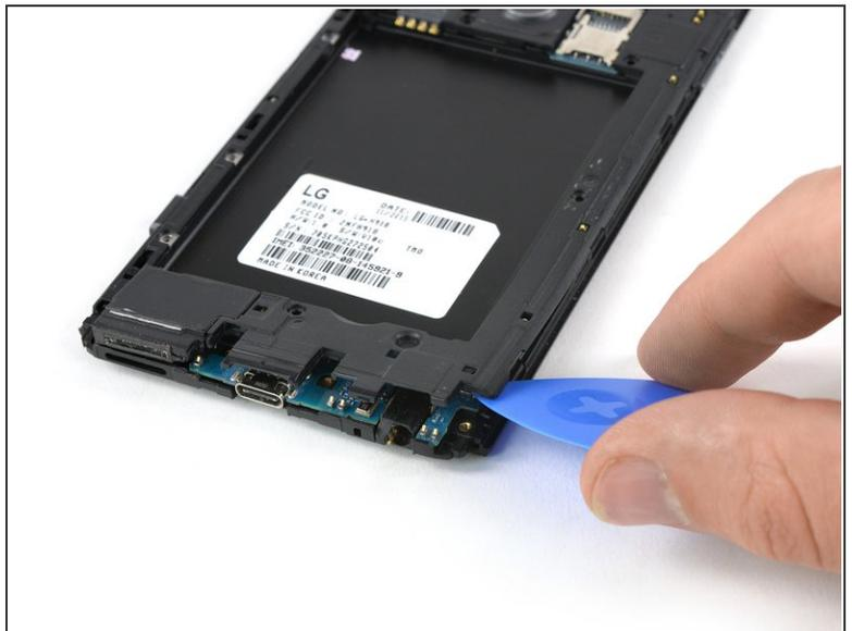
**i** Die Abdeckung des Motherboards ist mit mehreren Plastikklammern befestigt.
