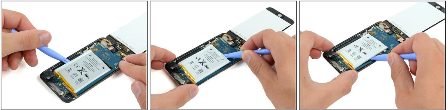
**⚠** In den nächsten Schritten wirst du den Kleber unter dem Akku, dem Logic Board und dem Rahmen unter dem Akku lösen. Arbeite langsam, sorgfältig und gleichmäßig. Achte darauf, dass du weder den Akku beschädigst noch das Logic Board verbiegst.
