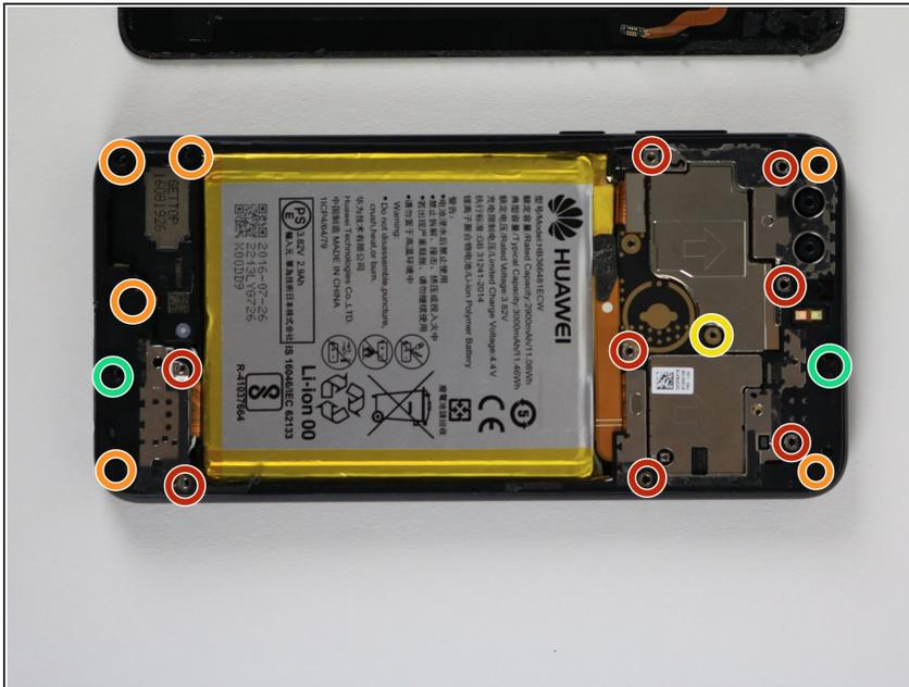
**i** Bewahre die winzigen Schrauben auf einer Magnetmatte oder einem sicheren Platz auf, so dass sie nicht verloren gehen. Insgesamt sind es achtzehn Schrauben.
