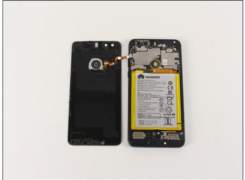
**!** Achte darauf, dass du das orangene Flachbandkabel beim Entfernen der Rückscheibe nicht zerreißt.
