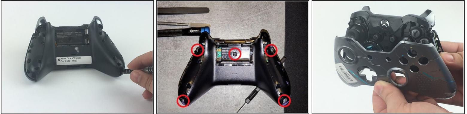
**i** Das Entfernen der seitlichen Griffe ermöglicht den Zugang zum Entfernen der Frontplatte.
